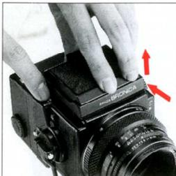
1) まず、カメラのウエストレベルファインダーEをはずします。ファインダー取りはずしボタンを押しながら、ファインダーを後方にスライドさせると、ウエストレベルファインダーEは、はずれます。
